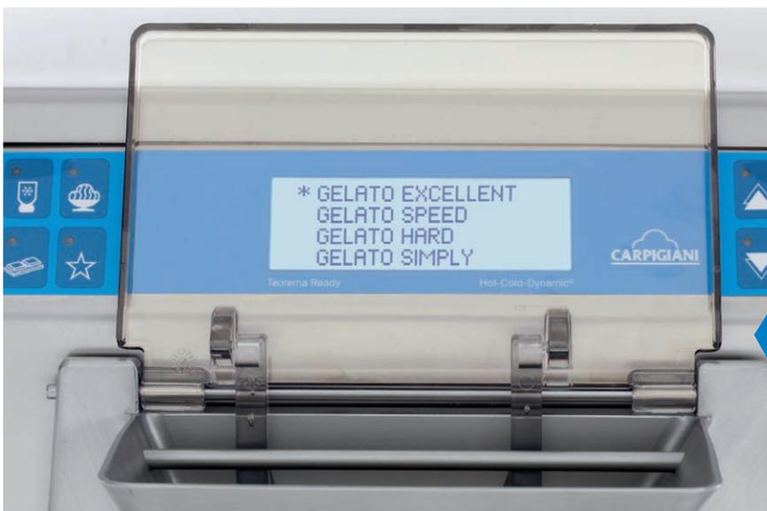
**Personalisierbare Produktionsmenüs**, damit NUR die am häufigsten verwendeten Produktionszyklen angezeigt werden.
