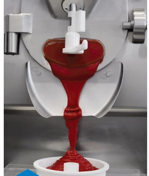
Dank des **Abstandhalters**, der jederzeit angebracht werden kann, ist es möglich, die Eisauslassöffnung zu reduzieren, um die Entnahme des Produktes Crystal und die Reinigung der Maschine zu erleichtern.
